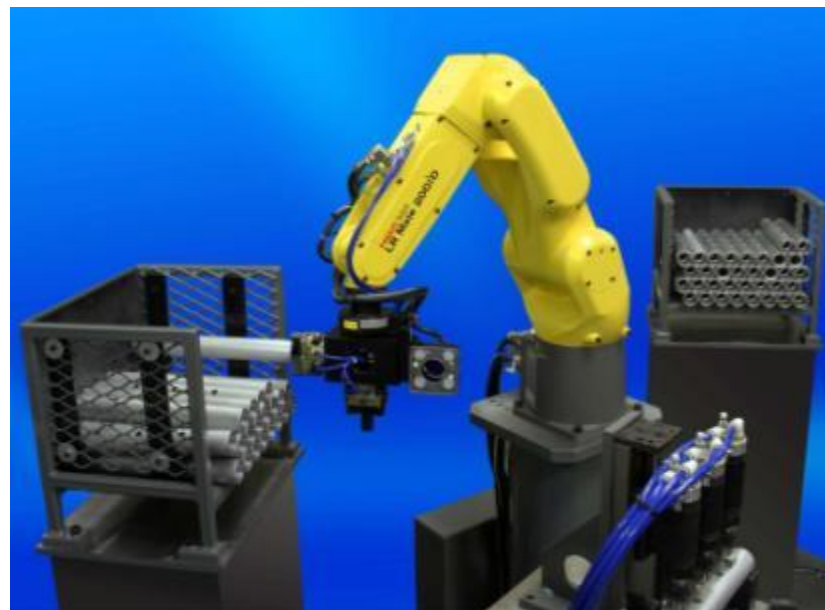
金属管件的重量检测与管口去毛刺（视觉+力传）
